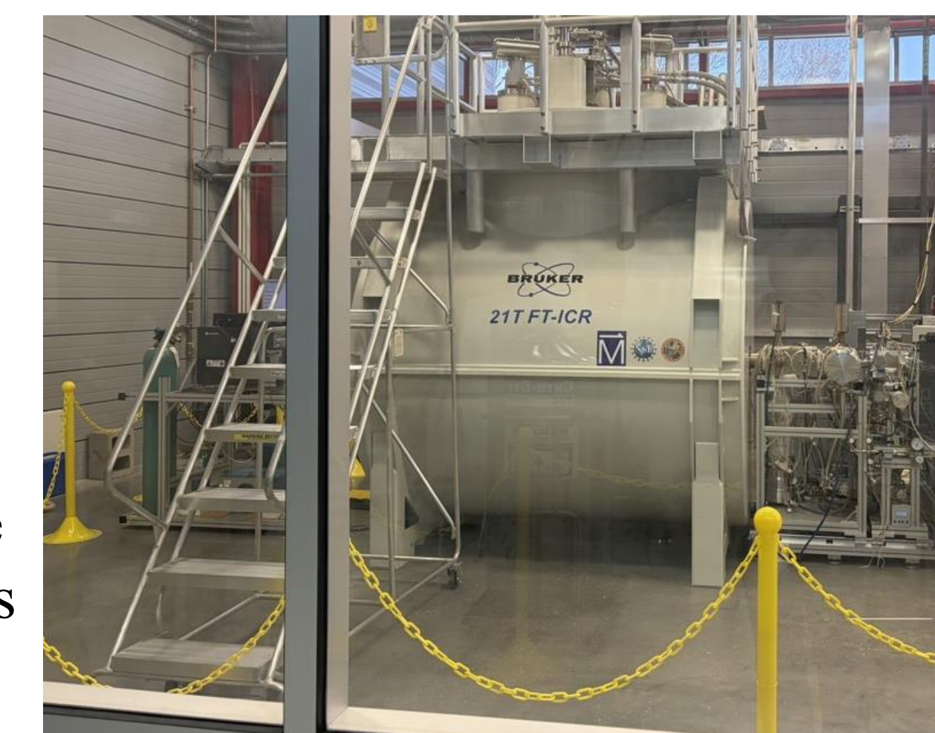
Fig. 6: 21-Tesla Bruker FT-ICR
